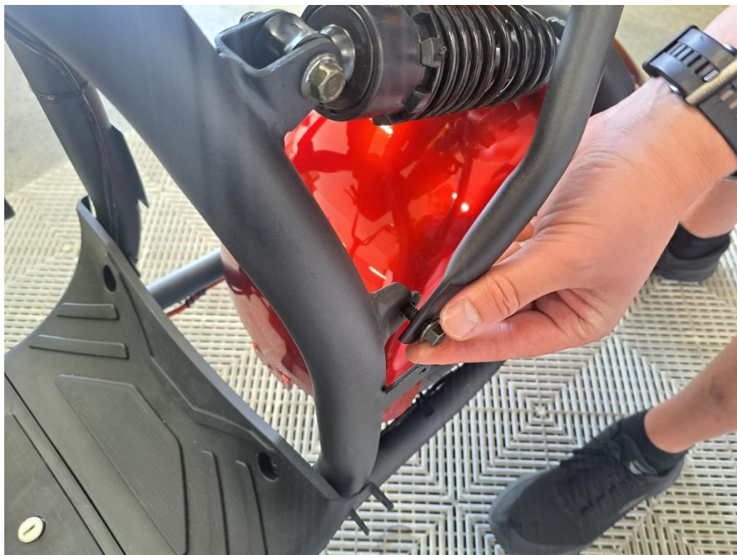
Fäst nedre delen av baksätets stomme med 10 mm bultar.
