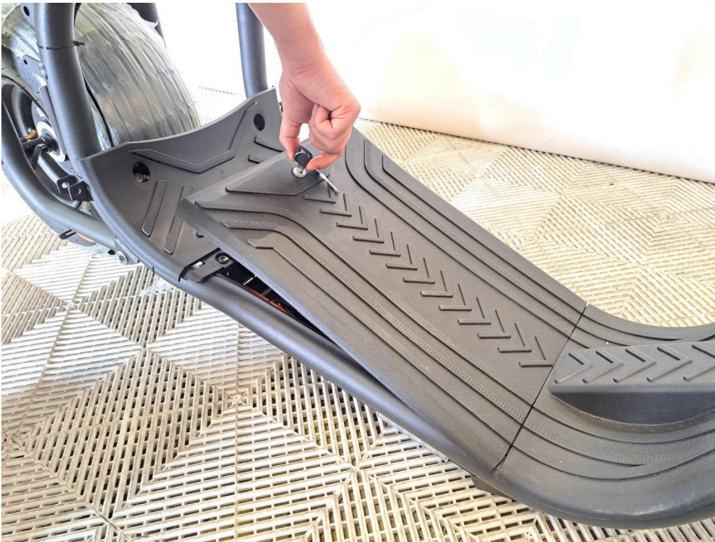
Öppna batterihöljets lock.
