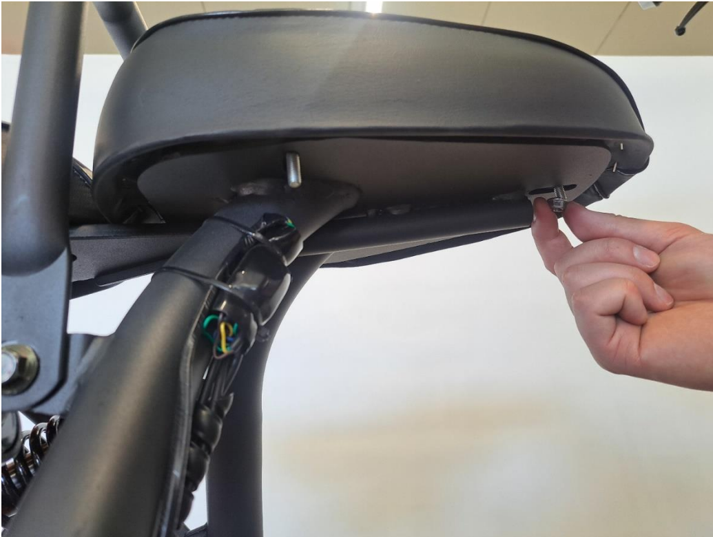
Montera förarsätet med tre 10 mm muttrar.
