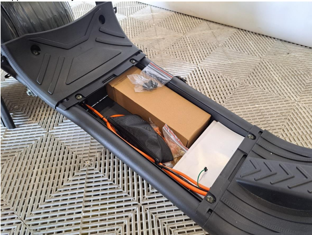
Öppna batterihöljets lock.
