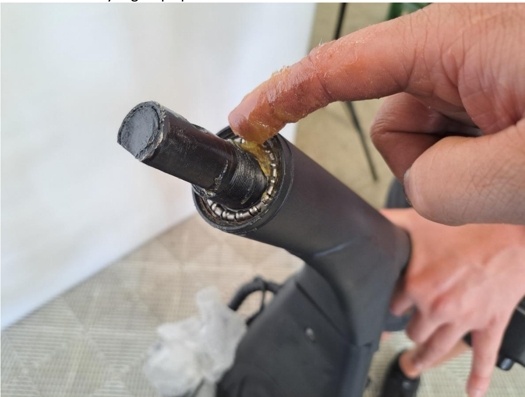
Sätt det övre styrlagret på plats.
