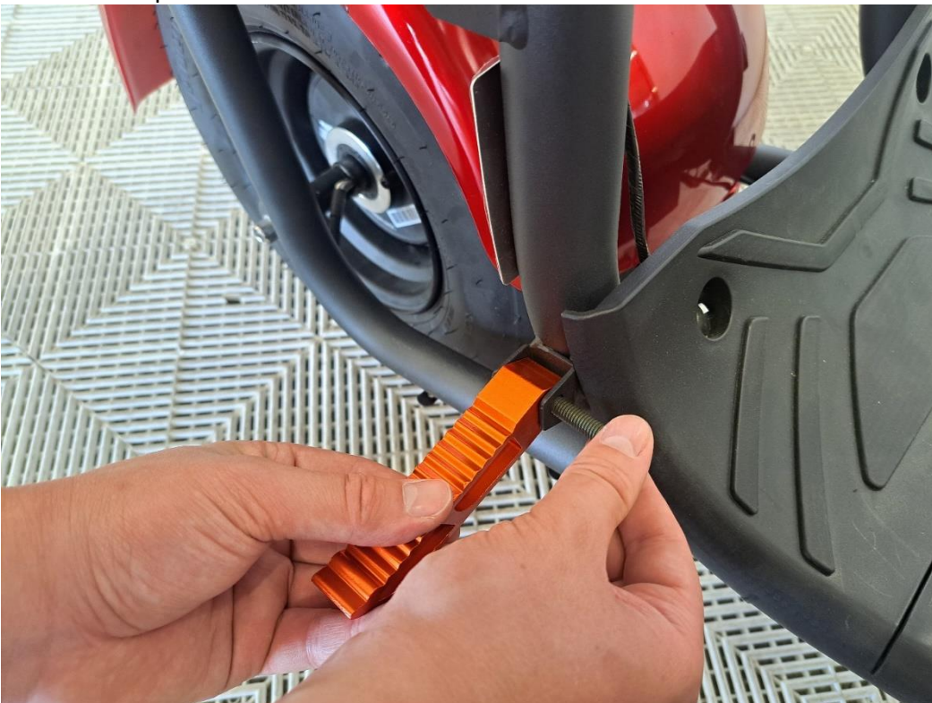
Fäst fotpinnarna med 10 mm bultar och 12 mm muttrar.
