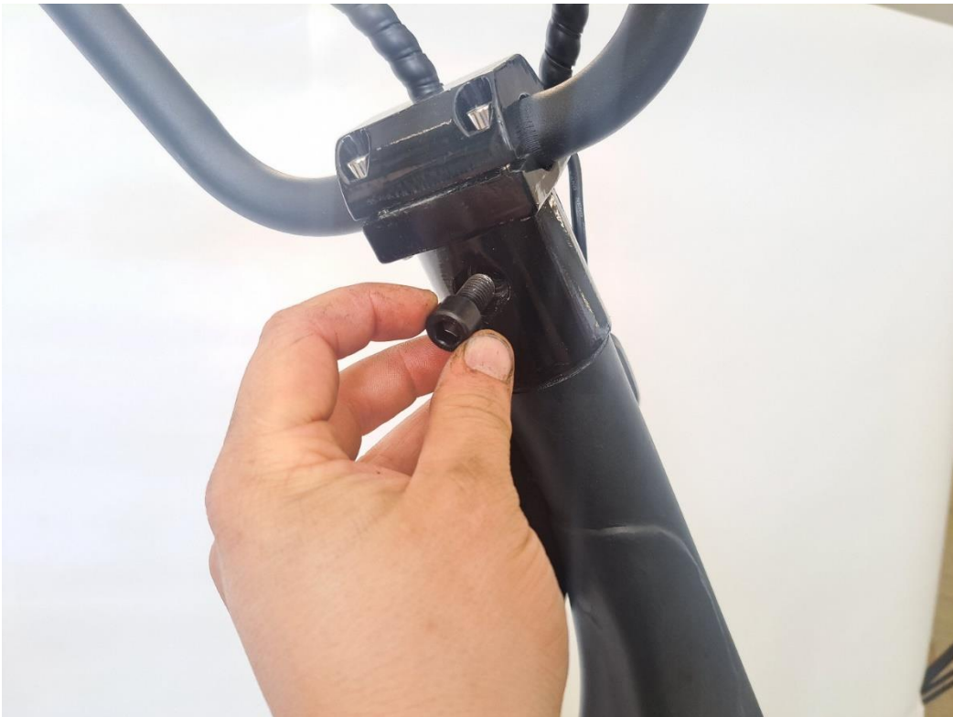
Fäst styrets fäststycke med en 8 mm insexbult.
