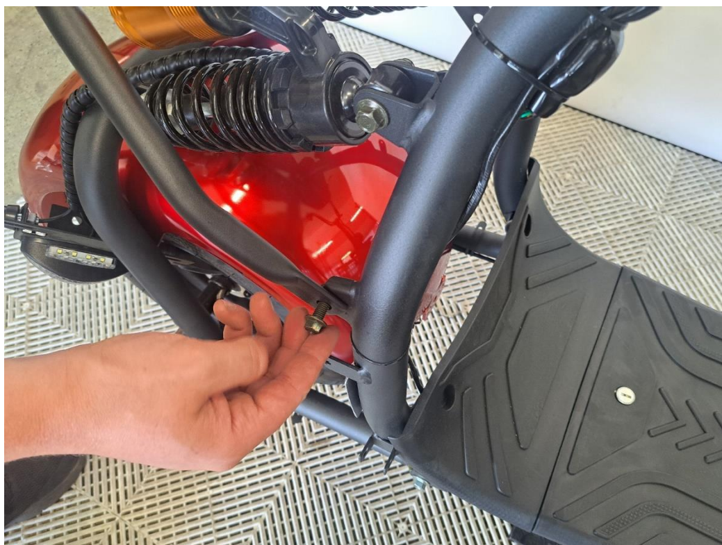
Fäst nedre delen av baksätets stomme med 10 mm bultar.
