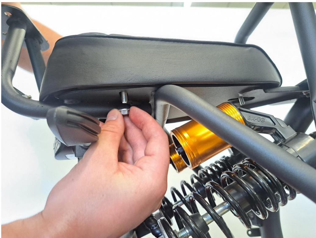
Fäst det extra sätet med tre 10 mm muttrar.
