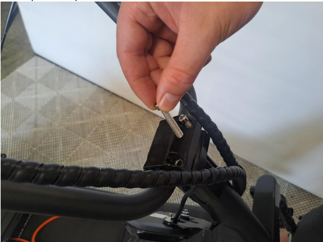
Lossa de främre insexbultarna på styrets fäststycke.
