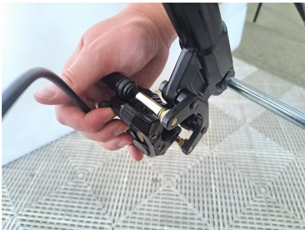
Fäst det främre bromsoket på glifstiften.
