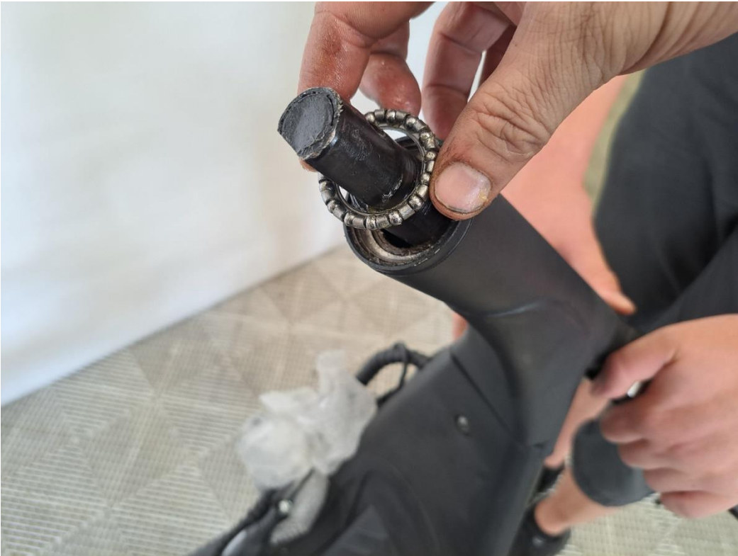
Sätt det övre styrlagret på plats.
